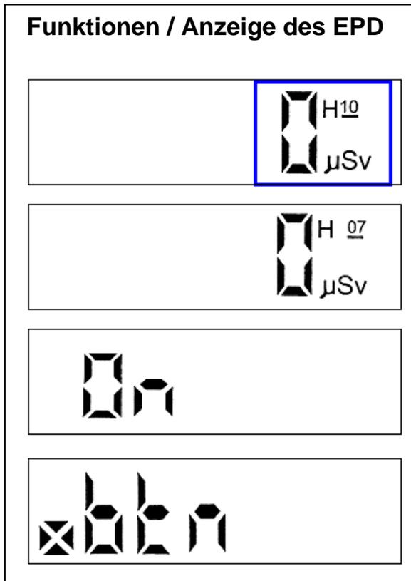
Durch unterschiedliches Drücken des Bedienknopfes können die Funktionen des Gerätes gewechselt und ausgewählt werden.
